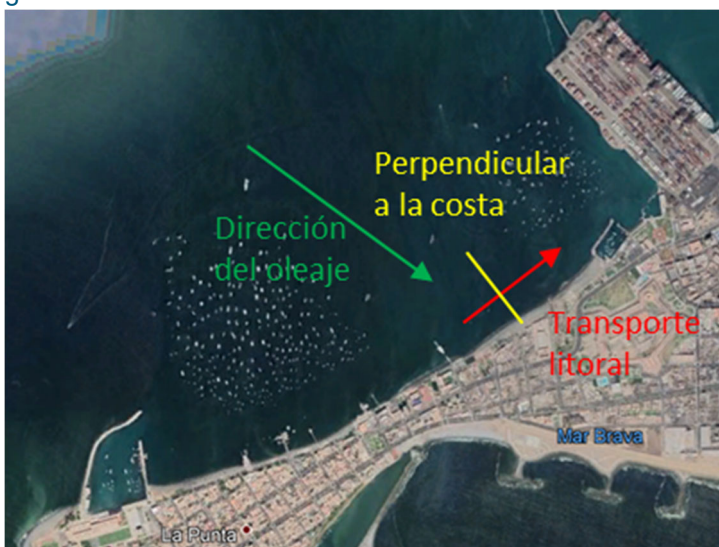
Figura 2-16: Esquema del transporte litoral.
