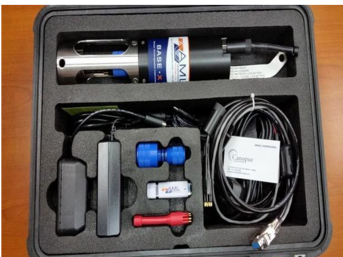
Figura 2-2: Sistema medidor de perfil de temperatura, salinidad, profundidad y velocidad del sonido (CTD)
