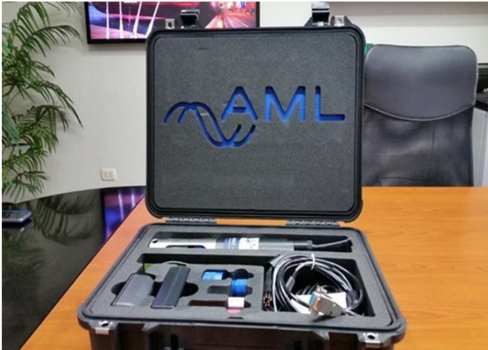
Figura 2-1: Sistema medidor de perfil de temperatura, salinidad, profundidad y velocidad del sonido (CTD)
