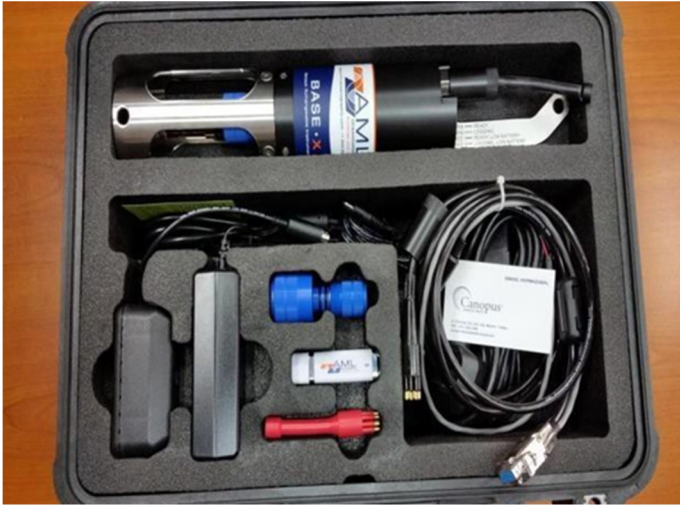
Figura 2-3: Sistema medidor de perfil de temperatura, salinidad, profundidad y velocidad del sonido (CTD)
