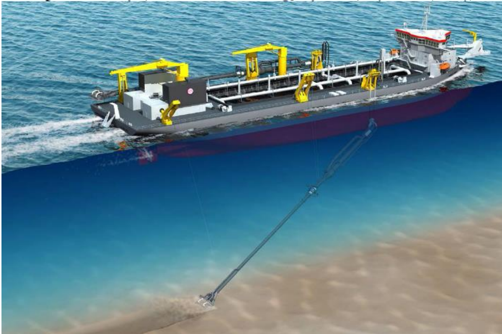
Figura 4-12 Esquema referencial de Draga Succión por Arrastre (THSD)
